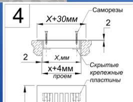
**Монтаж решеток производится на силикон-герметик или распорные пластины. Предусмотрен также и скрытый крепеж.**
