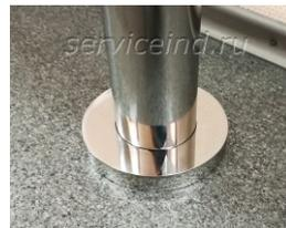
Основание -фланец имеет 160мм; комплектуется анкерами и колпачковыми (глухими) гайками М8-М10. Сварка производится по ГОСТу вольфрамовым электродом WL-20 с присадочной проволокой 1,6мм А2, в среде аргон.
